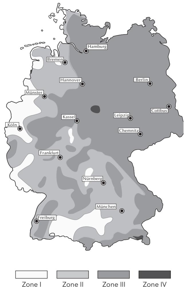
Bild 6 Schneelastzonenkarte von Deutschland zur überschlägigen Ermittlung der örtlichen Schneelastzone nach DIN 1055-T5. Eine exakte Angabe der Schneelastzone erfragen Sie bitte bei der örtlichen Baubehörde.
